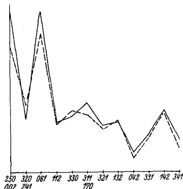
Fig. 7. Relative Intensitäten der restlichen vermeßbaren Intensitäten von Diaspor, gemessen und mit den endgültigen Parametern berechnet.
